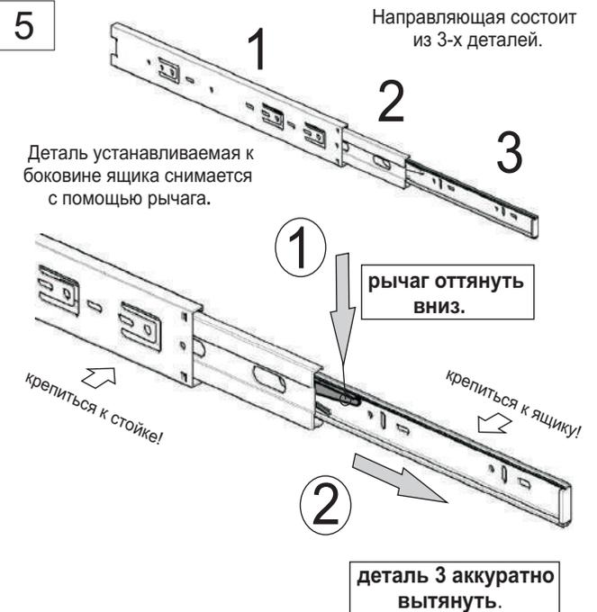
Деталь устанавливаемая к боковине ящика снимается с помощью рычага.
